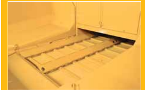
Enger Mitnehmerabstände auf den Kratzbändern sorgen für gleichmäßigen Mischguttransport.
