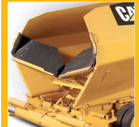
Die optional hydraulisch klappbare Frontschürze erleichtert die Reinigung.
