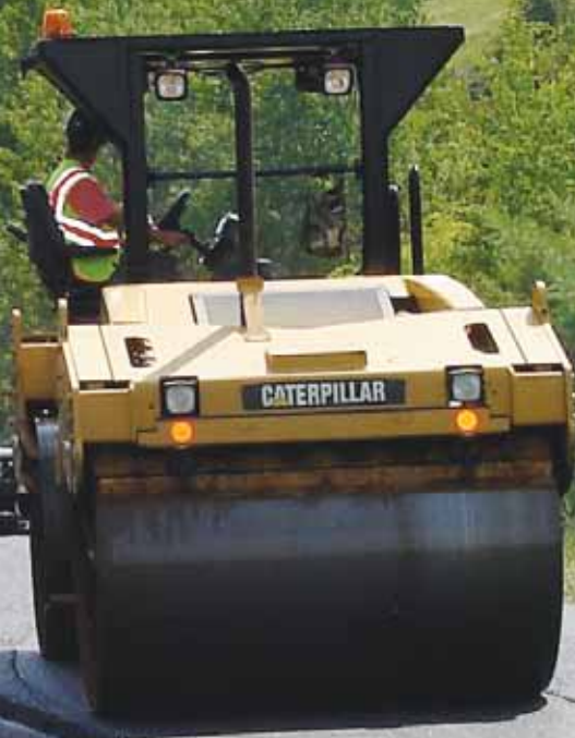
^ Eine 2-Meter – Walze von Cat® arbeitet in der heißesten Temperaturzone vor der Weichphase.
