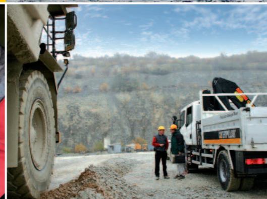
Messung der Nutzlast mit speziellem Meßwagen
